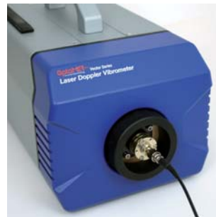
Faseroptische Messkopf ist austauschbar durch andere Objektiv
